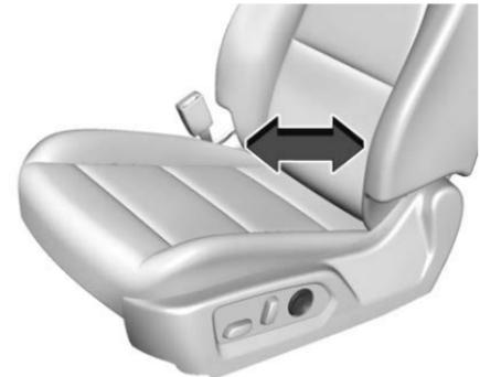
Si está equipado, oprima sin soltar la parte delantera o trasera del control para aumentar o disminuir el soporte lumbar.
