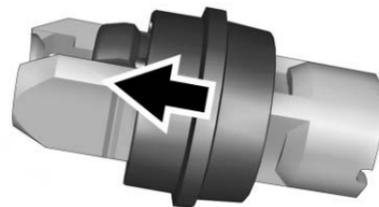
8. Verifique que el anillo de retención esté en la posición adecuada. Si el anillo del retenedor está fuera de posición, no se conectará. Vuelva a colocar el retenedor jalando hacia el frente con una herramienta.
