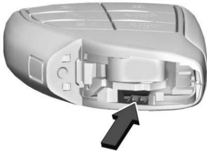
2. Use la hoja de la llave mecánica en la ranura para retirar la cubierta de la batería manualmente.
