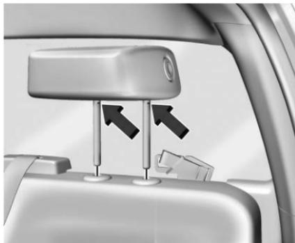
1. Inserte los postes de la cabecera o apoyacabezas en los orificios que se encuentran en la parte superior del
