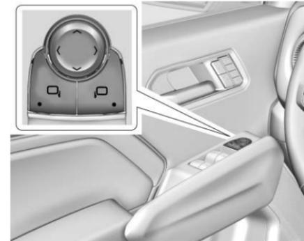
Si está equipado, ajuste los espejos eléctricos.
