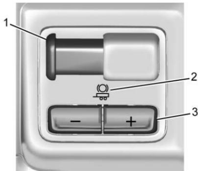
1. Palanca para aplicar el freno manual del remolque
