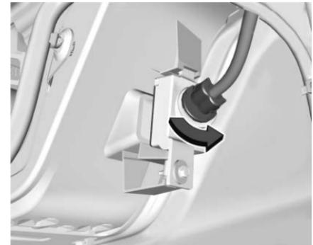
2. Gire el soporte del foco, en el lado posterior de la defensa, en sentido contrario a las manecillas del reloj para desconectarlo.
