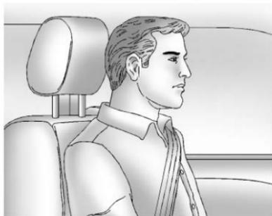
Ajuste las cabeceras de tal forma que la parte superior de la misma esté a la misma altura que la parte superior de la cabeza del
