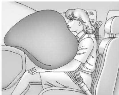
La bolsa de aire delantera del pasajero exterior está en el lateral del tablero de instrumentos.
