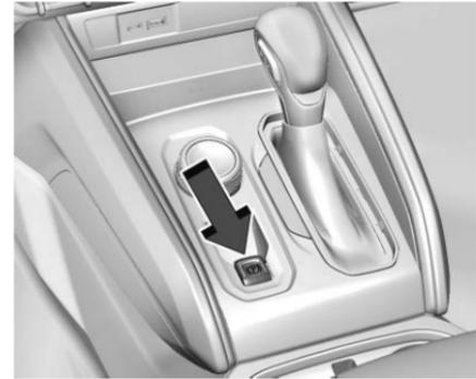
El Freno de estacionamiento eléctrico (EPB) siempre puede aplicarse, incluso con el vehículo apagado. En caso de falta de energía eléctrica, el EPB no puede activarse ni liberarse. Para evitar que se agote la batería, evite ciclos repetidos innecesarios del EPB.
