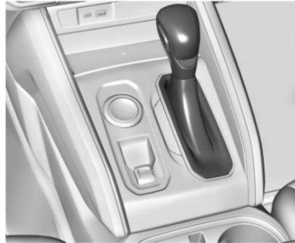
**P** : Esta posición bloquea las ruedas motrices. Utilice P (estacionamiento) al arrancar el motor, ya que el vehículo no puede moverse con facilidad. Cuando se encuentra estacionado en una colina, en particular cuando el vehículo lleva una carga pesada, puede percibir un incremento en el esfuerzo para cambiar fuera de P (estacionamiento). Vea "Bloqueo de torque" en *Cambio a PARK (estacionamiento)* ⇨ 179.
