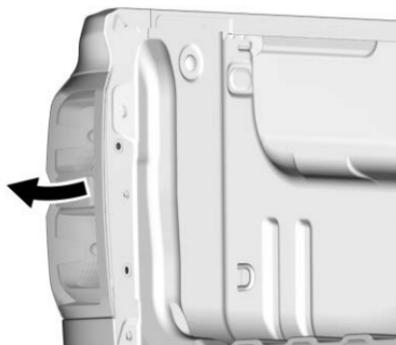
4. Jale el ensamblaje de la luz trasera de forma recta hacia atrás para retirarlo del vehículo. Esto puede requerir un fuerte tirón para aflojar los sujetadores. Habrá un ruido cuando los retenedores se liberen.
