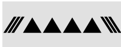
Cuando su vehículo se aproxime a otro vehículo detectado demasiado rápido, las luces rojas FCA parpadearán en el parabrisas. Además, sonarán ocho pitidos agudos rápidos desde el frente. Cuando se produce esta Alerta de colisión, el sistema de frenos puede prepararse para que el frenado del conductor ocurra más rápidamente, lo cual puede causar una desaceleración breve y suave. Continúe aplicando el pedal de freno según se requiera.
