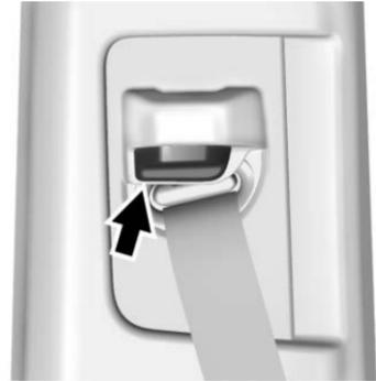
Presione hacia arriba el botón de liberación y mueva el ajustador de altura a la posición deseada.
