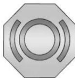
El depósito del cilindro maestro de frenos se llena con líquido de frenos DOT 4 aprobado por GM, como se indica en el tapón del depósito. Vea en *Vista general del compartimiento del motor* ⇨ 277 la ubicación del depósito.
