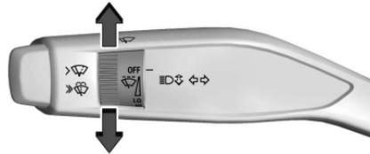
La palanca del limpiaparabrisa/lavador está del lado izquierdo de la columna de dirección. Con la ignición encendida o en modo de accesorios, mueva la perilla del limpiaparabrisa para seleccionar la velocidad del limpiador.
