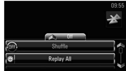
**Aleatorio:** Presione la perilla MENU para activar o desactivar el modo de reproducción aleatoria. No todos los dispositivos soportan el modo de reproducción aleatoria.
