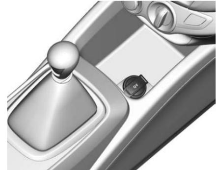
Si está equipado con tomacorriente, el vehículo tiene un tomacorriente de 12 voltios que se pueden usar para conectar equipo eléctrico, como un teléfono celular o un reproductor MP3.
