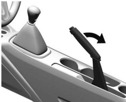
El freno de estacionamiento funciona en las ruedas traseras.
