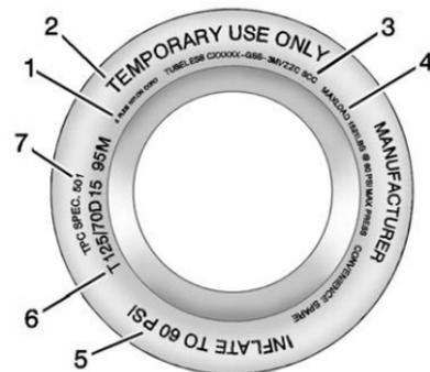
**Ejemplo de llanta de refacción compacta**
