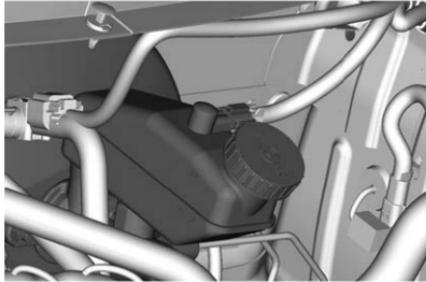
Con el vehículo en P (estacionamiento) en una superficie nivelada, el nivel de fluido de freno debe estar entre las marcas mínimo y máximo en el depósito del fluido de freno.
