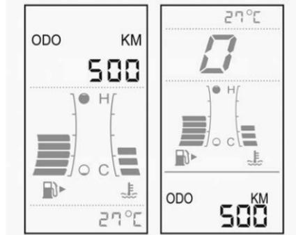
El odómetro muestra que tan lejos se ha conducido el vehículo, en kilómetros.
