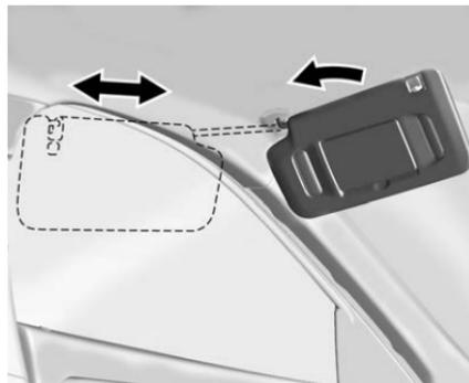
Tire de la visera hacia abajo para bloquear el resplandor. Desconecte la visera del montaje central para girarlo a la ventana lateral, o para extenderla a lo largo de la varilla.
