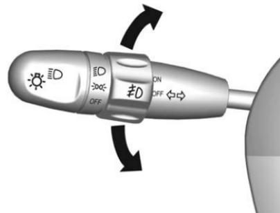
Mueva la palanca completamente hacia arriba o hacia abajo para señalar una vuelta.
