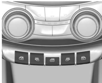
Las ventanas eléctricas funcionan cuando la ignición está en encendida, en ACC/ACCESSORY (Accesorios), o en Energía retenida para los accesorios (RAP). Consulte Energía retenida para Accesorios (RAP).
