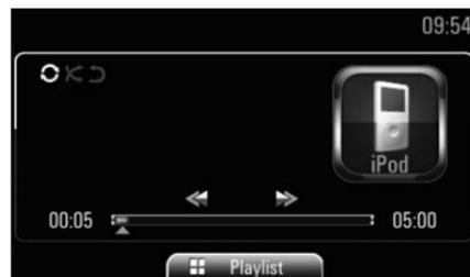
iPod se puede conectar al sistema de infoentretenimiento. Cuando está conectado, el iPod puede ser operado a través de los controles y menús en el sistema de infoentretenimiento.
