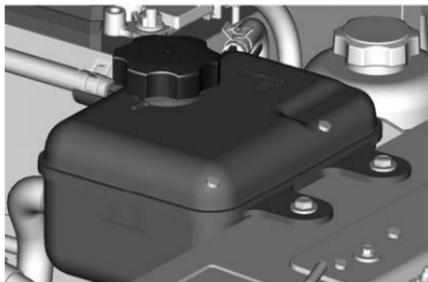
3. Llene el tanque de compensación del refrigerante con la mezcla adecuada hasta la marca de nivel indicado.
