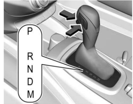
El botón de liberación de la palanca de cambios necesita oprimirse al cambiar entre velocidades particulares.
