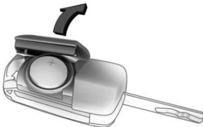
1. Despliegue la llave, y abra la cubierta de la caja de la batería.
