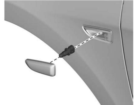
1. Utilice una herramienta plana para sacar cuidadosamente el receptáculo del foco del borde de la luz direccional delantera.
