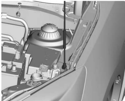
3. Libere la varilla de apoyo del cofre del sujetador de retención debajo del cofre. Gire la varilla de apoyo del cofre hacia abajo e inserte su extremo libre firmemente en el hueco de la defensa.
