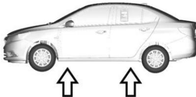
4. Coloque el gato hidráulico en la posición marcada con una marca.
