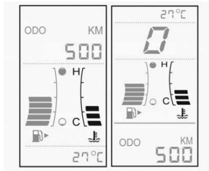
Si está equipado, este indicador mostrará el valor de temperatura del refrigerante del motor cuando la ignición esté encendida.
