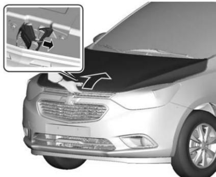
2. Empuje la palanca de seguridad hacia el lado derecho y levante el cofre.
