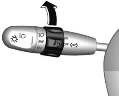
☞ : Si está equipado, mientras las luces de estacionamiento estén encendidas, gire la banda de la luz antiniebla delantera para encender o apagar las luces antiniebla
