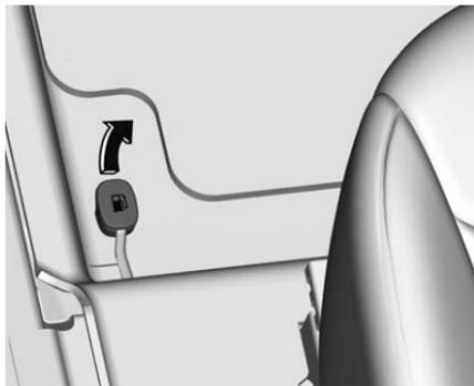
Para abrir la puerta de llenado de combustible, levante la palanca de liberación de la puerta de
