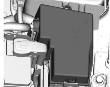
El bloque de fusibles del compartimiento del motor se encuentra junto al reservorio de refrigerante
