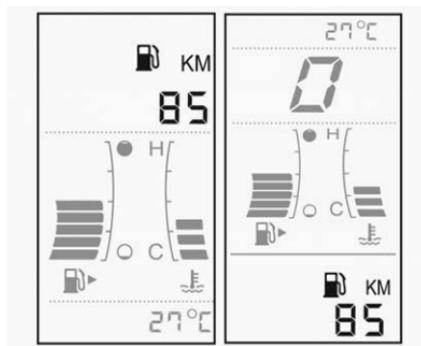
Este modo indica la distancia de conducción calculada para vaciarse a partir del combustible actual en el tanque de combustible.
