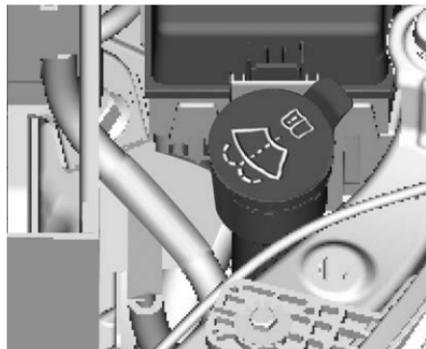
Abra el tapón que tiene el símbolo del lavaparabrisas. Agregue líquido para lavaparabrisas hasta llenar el tanque.
