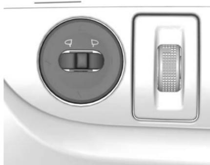
Los espejos exteriores se pueden ajustar en cuatro direcciones usando el interruptor del espejo que está ubicado en el tablero de instrumentos en el lado izquierdo del volante. El interruptor de ignición debe estar encendido o en ACC/ACCESSORY (accesorios) para que opere esta función.
