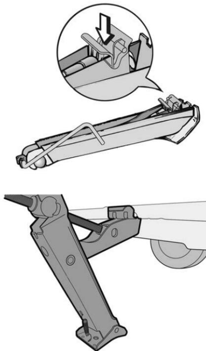
5. Coloque la cabeza del gato hidráulico alrededor de la oreja vertical e insértelo en la ranura de la oreja.
