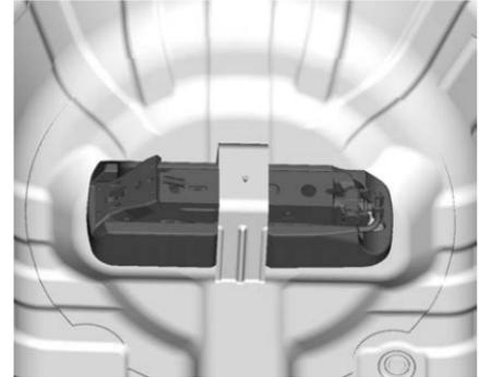
5. Retire el gato hidráulico y las herramientas de su contenedor y colóquelos cerca de la llanta que se va a reemplazar.
