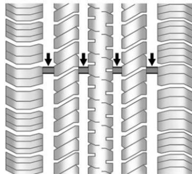
Los indicadores de desgaste del dibujo son una de las maneras de decidir cuándo es el momento para nuevas llantas. Los indicadores de desgaste aparecen cuando las llantas tienen solamente 1.6 mm (1/16 de pulgada) de dibujo
