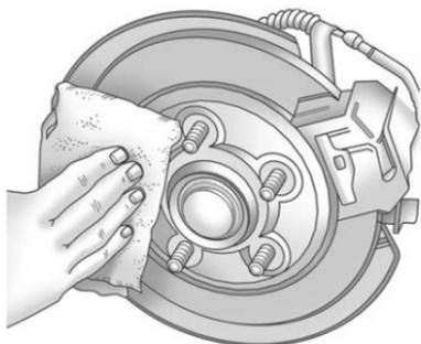
10. Elimine todo el óxido y la suciedad de los pernos de la rueda, las superficies de montaje y la rueda de refacción.
