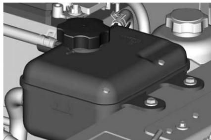
Revise si se alcanza a ver refrigerante en el tanque de compensación del refrigerante. Si el refrigerante que está dentro del tanque de compensación del refrigerante está hirviendo, no haga nada más hasta que se enfríe.
