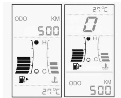
Al activar la ignición, el indicador de combustible muestra cuánto combustible queda en el tanque. Una flecha en el indicador de combustible muestra el lado del vehículo en donde se encuentra el tanque. No deje que el tanque de combustible se seque.
